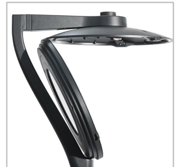
FLEXIA FG: elektrische Trennung beim Öffnen, LED-Einheit werkzeuglos abnehmbar.
