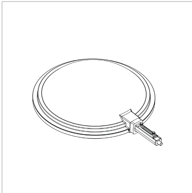
CITEA NG2 | Mastansatzmontage mit Gelenk Überschub Ø60mm (A6)
