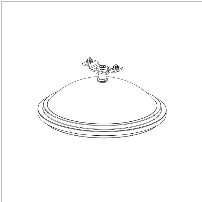
CITEA NG2 | Seilauhängungsmontage mit Gelenk 1" Außengewinde (S4)
