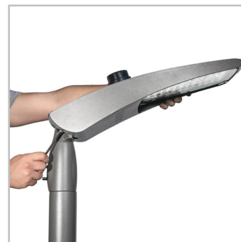
Der Neigungswinkel ist für Mastaufsatz (0 bis +15°) und Mastansatz (0 bis -15°).
